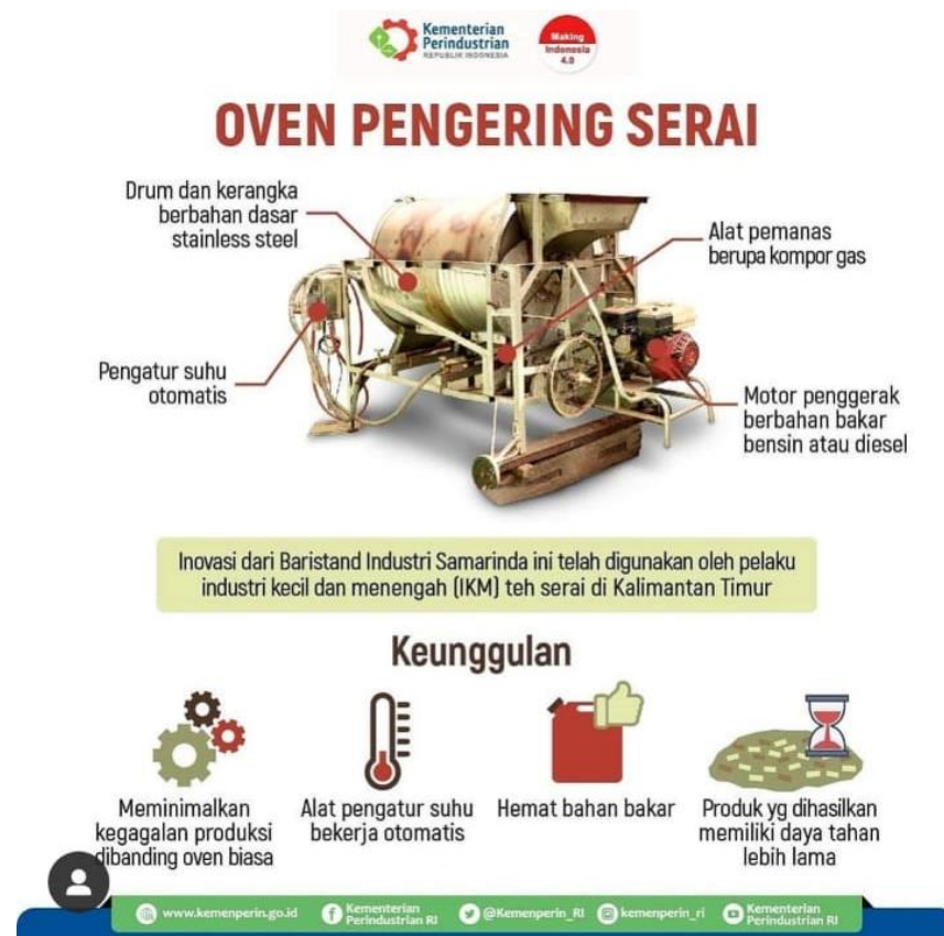
Gambar 8. Skema Teknologi Hasil Litbangyasa Oven Pengering Serai yang Dimanfaatkan di Industri
