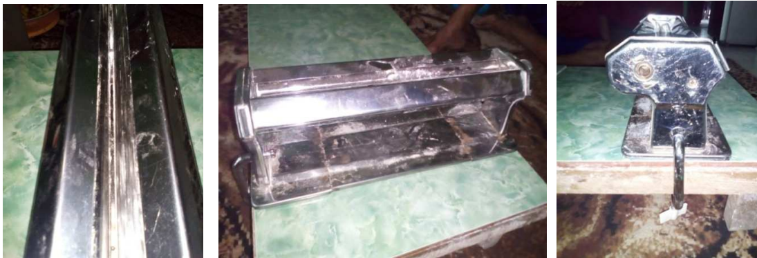
Gambar 4. Alat Penggiling Cireng yang Telah Dimodifikasi
